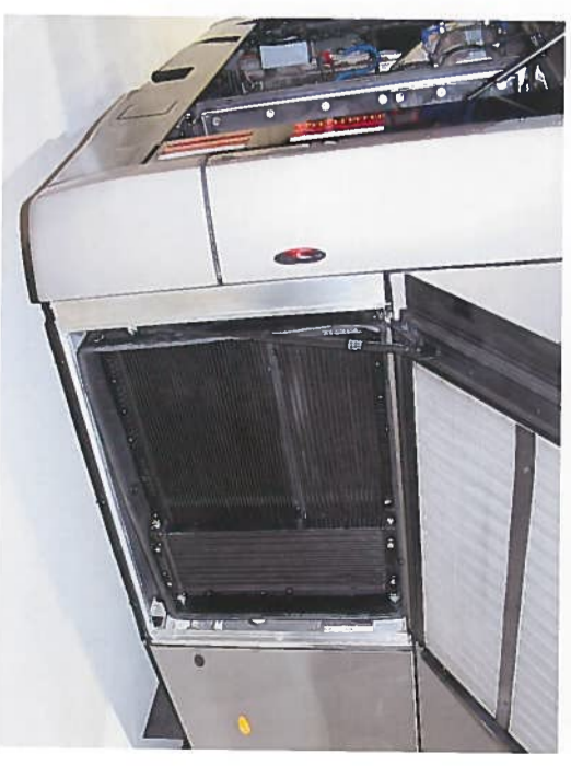
Der Kühler befindet sich rechts im Heck des EX.
