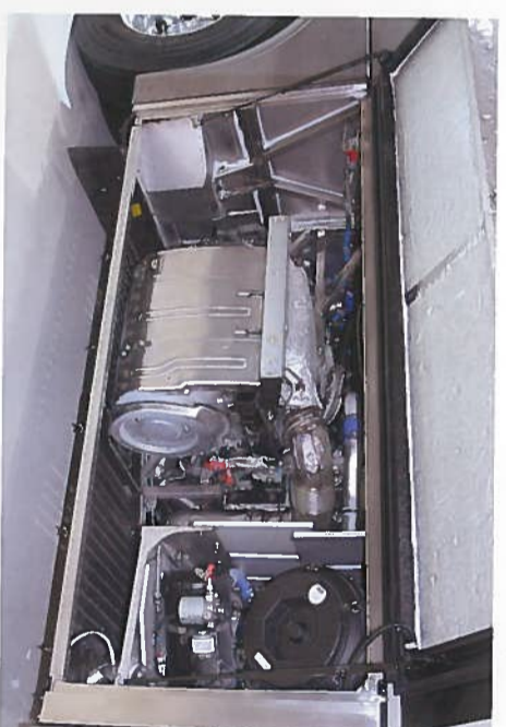
Links im Heck befindet sich die Abgasanlage des EX. SCR-System und Partikelfilter wurden in einer kompakten Einheit zusammengefasst.
