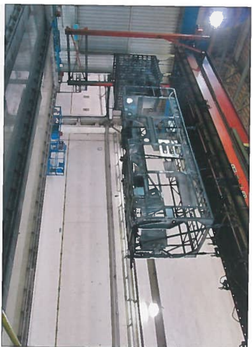
Korrosionsschutz durch Kathodische Tauchlackierung (KTL): im Bild der Hinterrahmen eines viertrigen Gelenkbusses
