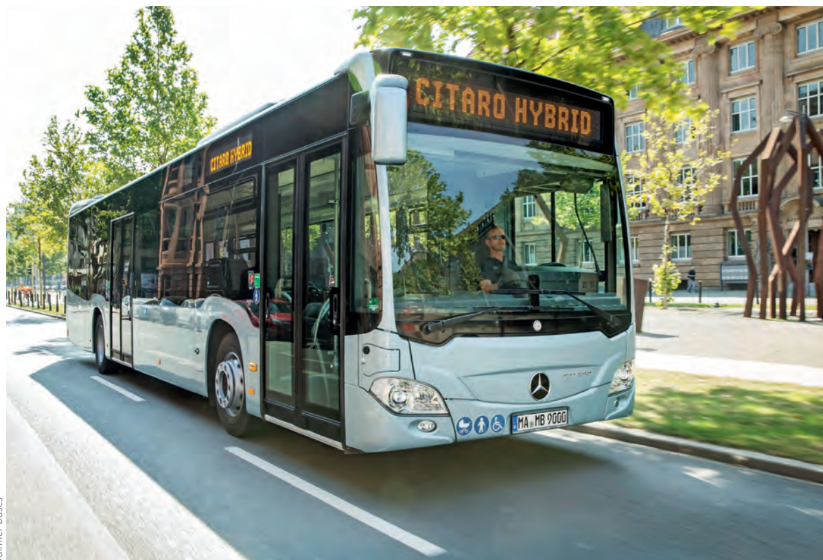
Der neue Mercedes-Benz Citaro Hybrid-Solobus mit Euro VI Dieselmotor und Hybridmodul.
