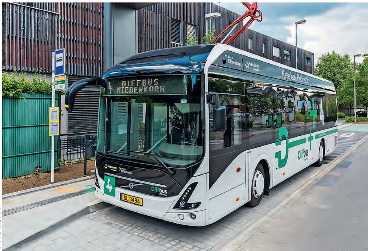
Volvo präsentiert den 7900E-(electric)-Solobus. Die Nachladung der Batterien erfolgt mittels Lademast und Pantograph.
