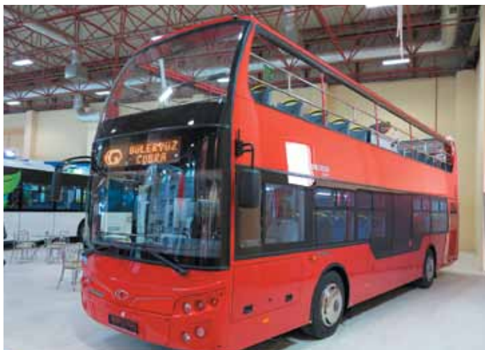
Двухэтажный автобус Guleryuz Cobra Double Decker вмещает до 62 пассажиров и может оснащаться турбодизелями Cummins, DAF, MAN или Mercedes-Benz
