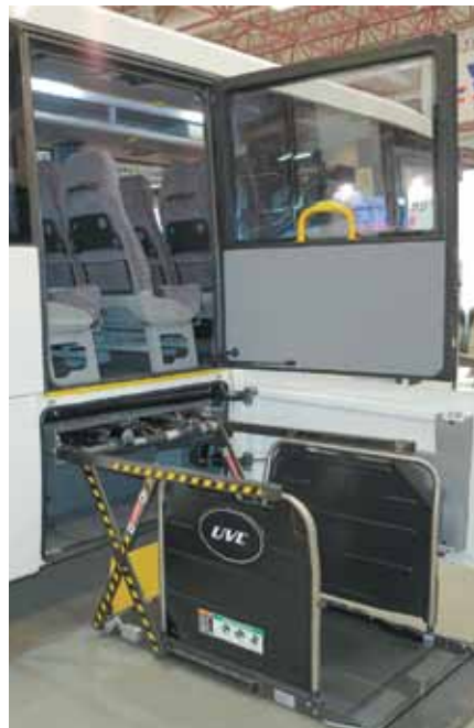
Автобус Otokar Sultan Maxi был представлен с подъемником для инвалидных колясок
