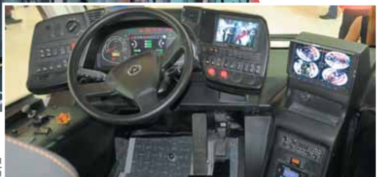
Водительское место AKIA Ultra LF25 Metrobus оснащено множеством мониторов, передающих изображение с видеокamer
