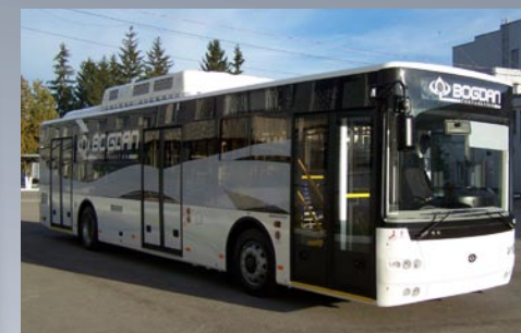
Украину на выставке представлял гибридный низкопольный автобус «Богдан А70522», с улучшенной на 35% топливной экономичностью.
