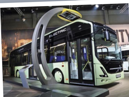
Электробус Volvo 7900 Electric Bus подзаряжается на остановках при помощи специального пантографа на крыше.
